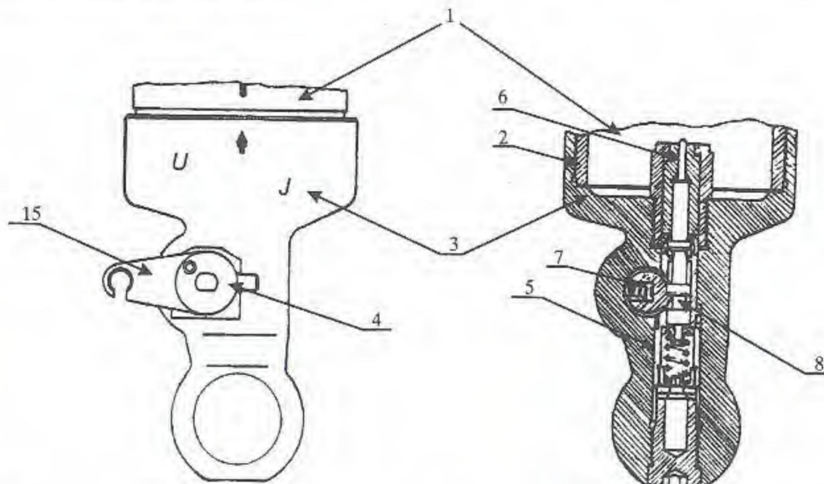
Слика 20. Положај делова механизма за запињање и окидање и механизма за опаљивање при брзој пљбби
